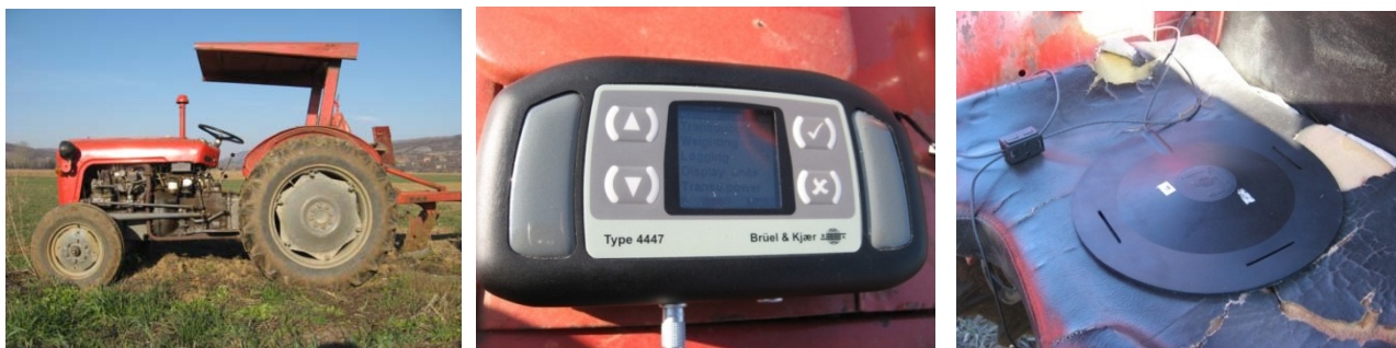
Slika 3. - Traktor korišćen u merenju i analizator vibracija Brüel & Kjær 4447
