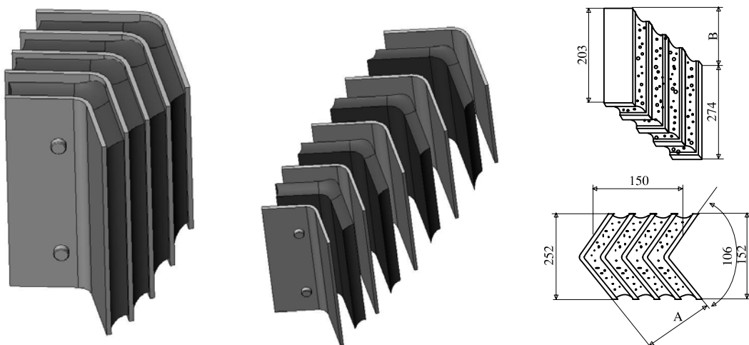
Слика 1. Изглед и структура гумено-металних елемената примарног огибљења (ознака L9)
