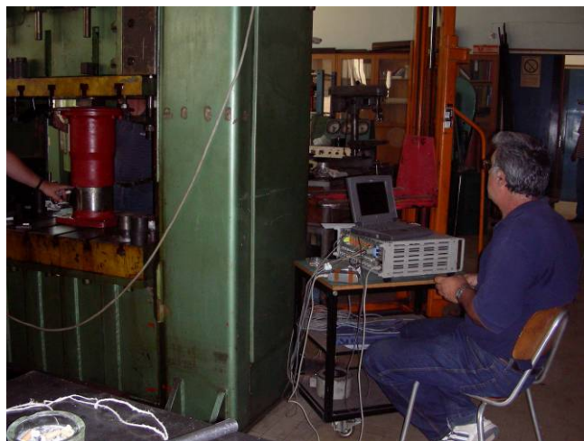
Слика 5 Структурна шема (а) и реални изглед (б) мерног места за статичка испитивања одбојника
