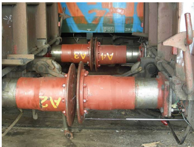
Слика 7 Одбојници у испитивању налетањем вагона
